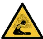
Atenție! Atmosferă asfixiantă. Nu porniți utilajul în spații închise.
