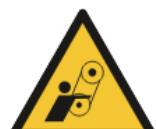
Atenție! Nu porniți utilajul cu protecția curelelor demontată.
